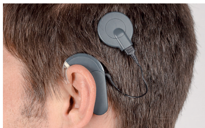
Εικ. 5 Το SONNET πίσω από το αυτί και ο πομπός επάνω από την περιοχή του εμφυτεύματος
