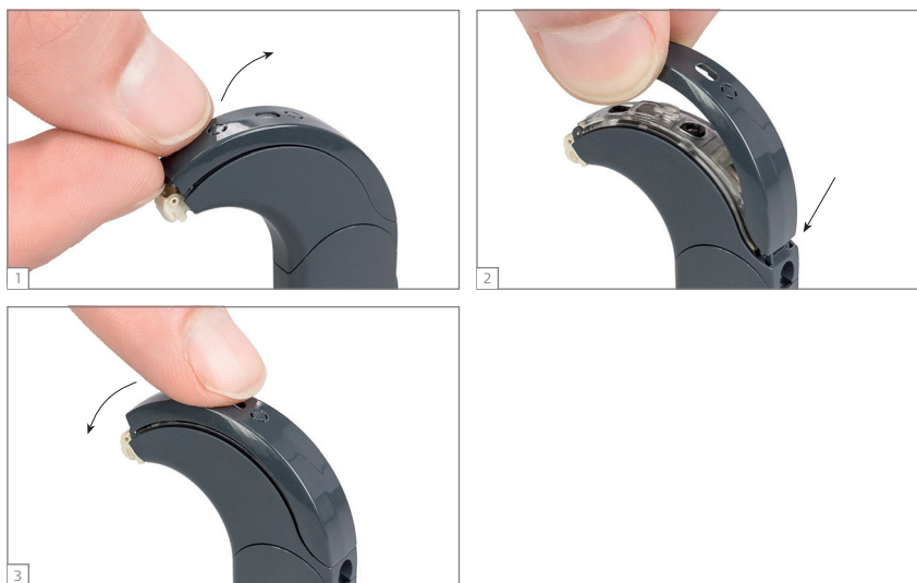
Εικ. 33 Αφαίρεση και τοποθέτηση του καλύμματος του μικροφώνου
