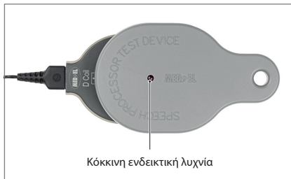
Εικ. 37 Συσκευή ελέγχου του ακουστικού επεξεργαστή (Speech Processor Test Device)
