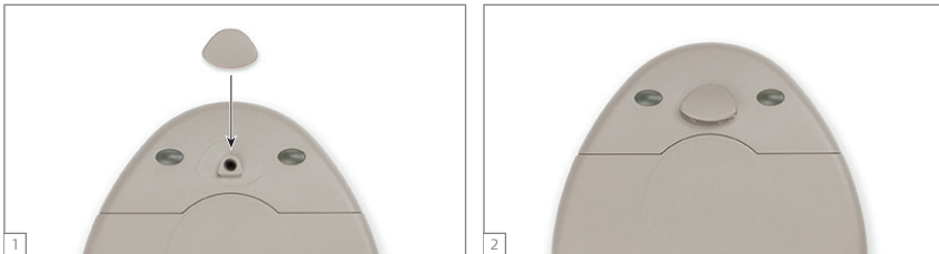
Εικ. 13 Τοποθέτηση του καλύμματος του μικροφώνου
