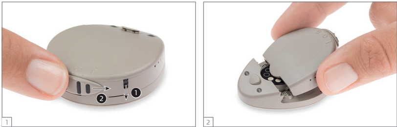
Εικ. 14 Πώς να ανοίξετε το πακέτο μπαταριών του ακουστικού επεξεργαστή RONDO
