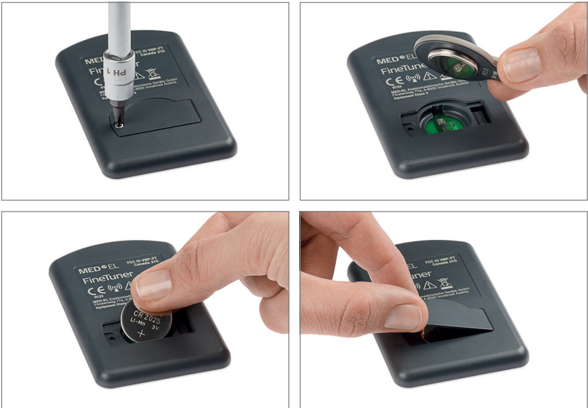
Εικ. 24 Αλλαγή μπαταρίας στο FineTuner
