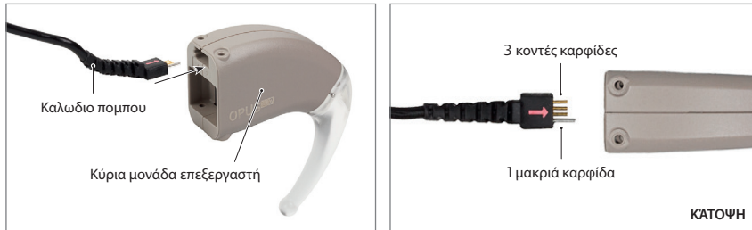
Εικ. 14 Τοποθέτηση του καλωδίου πομπού
