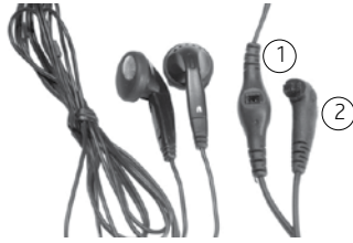
Σχήμα 16: Βύσμα εξαρτήματος/συστήματος FM (1) και βύσμα επεξεργαστή (2) στα ακουστικά ελέγχου
