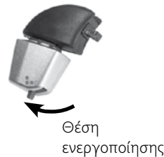
Σχήμα 25: Δέκτης Phonak συνδεδεμένος στον προσαρμογέα πρόσθετων εξαρτημάτων Euro
