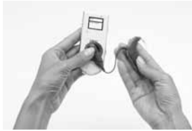
Σχήμα 14: Τοποθέτηση του πηνίου στην πίσω πλευρά του τηλεχειριστηρίου
