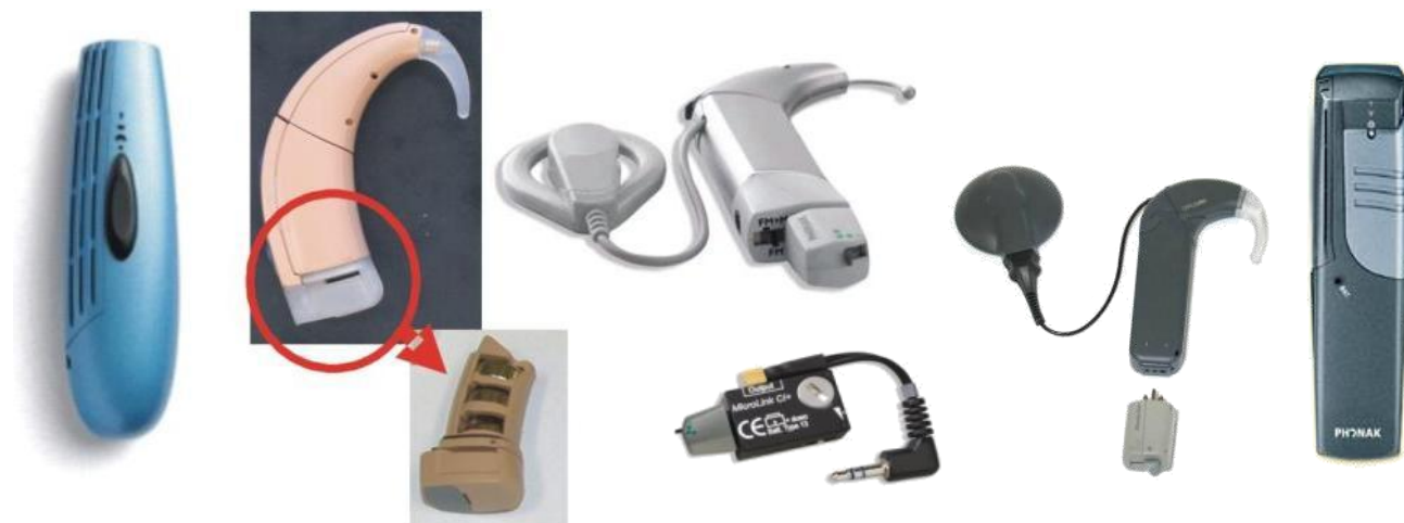
Εικόνα 11. Συστήματα FM που προσαρμόζονται στον επεξεργαστή ομιλίας.
