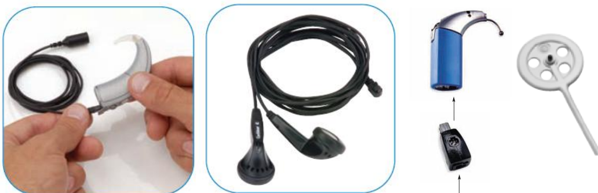
Εικόνα 12. Παράδειγμα εξωτερικού μικροφώνου, εξωτερικών ακουστικών ελέγχου, προσαρμογέα ακουστικών και μικροφώνου και ελεγκτή σήματος.
