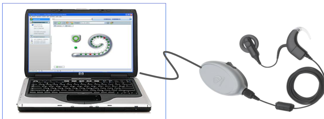
Εικόνα 10. Η σημερινή συνδεσμολογία, με ταχύτερα και πιο εξελιγμένα προγράμματα ελέγχου και ρύθμισης του ΚΕ.
