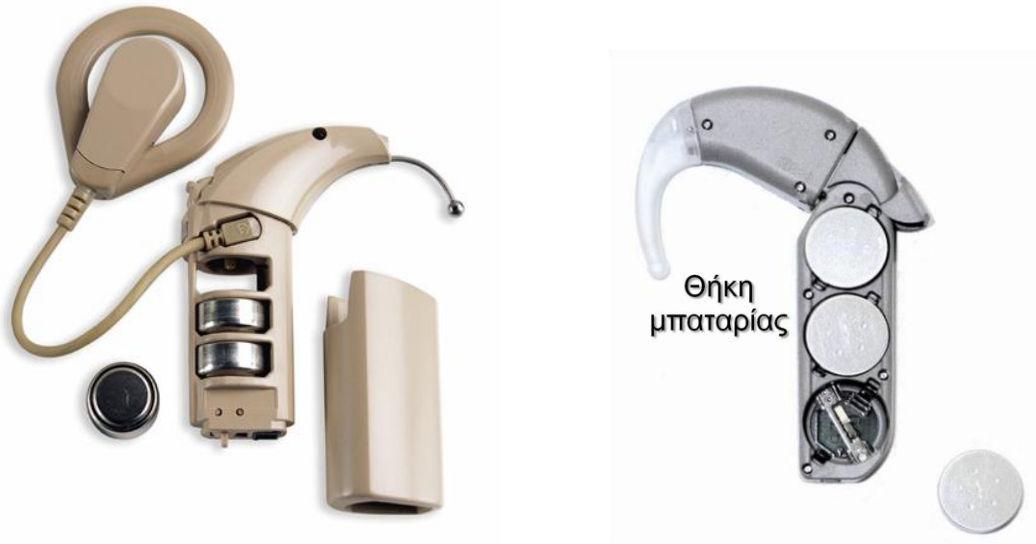
Εικόνα 14. Αλλαγή μπαταριών στους επεξεργαστές 3G και OPUS 2.
