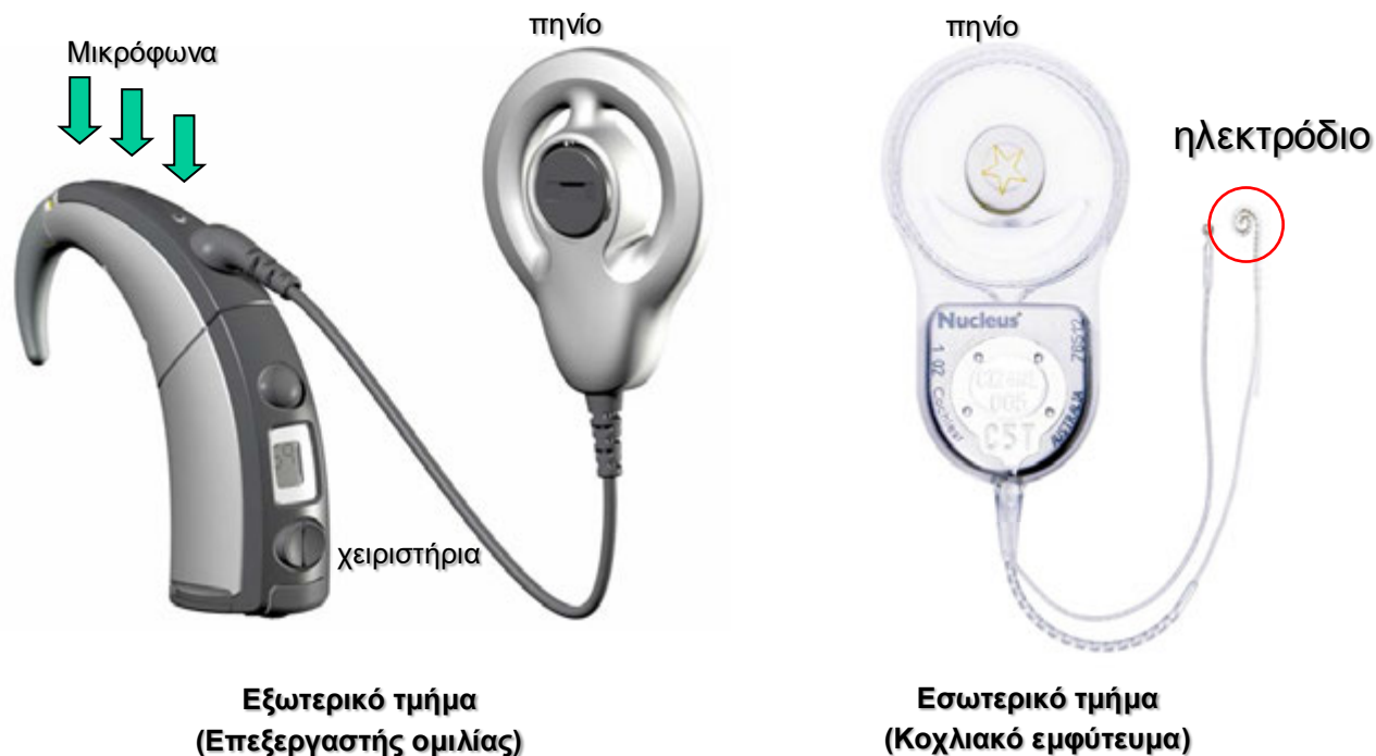
Εικόνα 1. Το σύστημα του κοχλιακού εμφυτεύματος.
