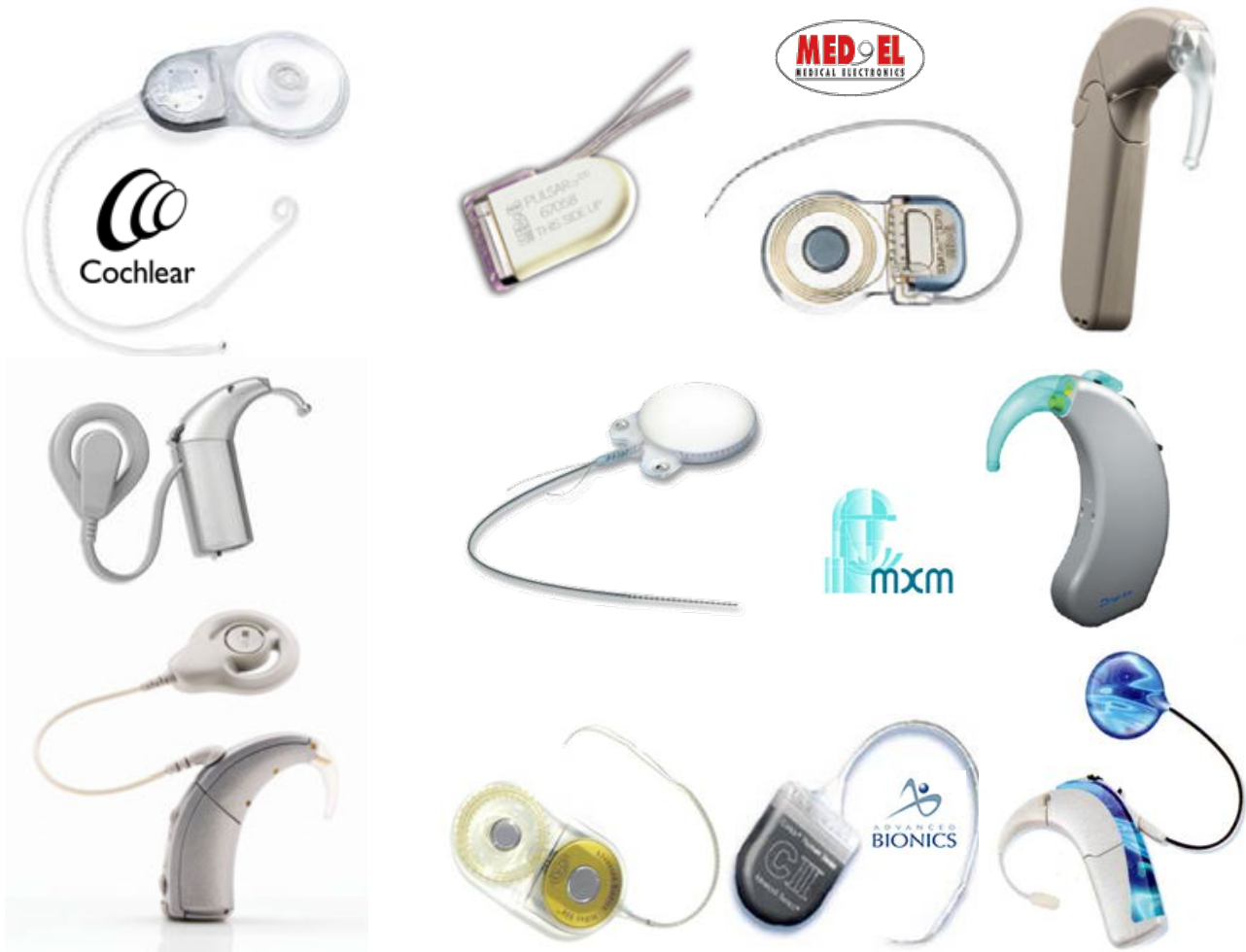
Εικόνα 2. Οι τύποι κοχλιακών εμφυτευμάτων με τους αντίστοιχους επεξεργαστές ομιλίας.
